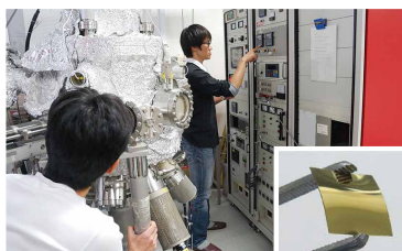
分子線エピタキシー装置を使った実験風景 (挿入図：フレキシブル基板上に形成した次世代半導体結晶)
