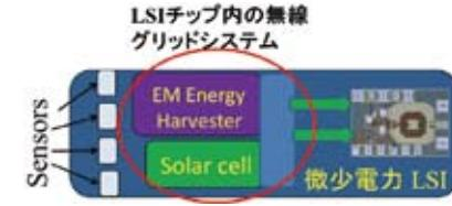
図3 バッテリーレスセンサノードのイメージ
