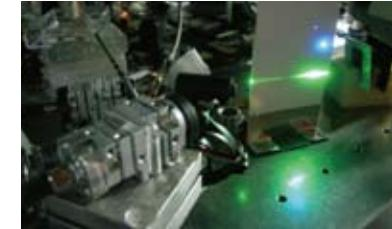
図3 ダイオード励起パルス固体レーザー(青・緑)の開発
