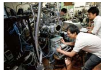
プラズマを用いた太陽電池作製装置で「新型太陽電池」を作製中
